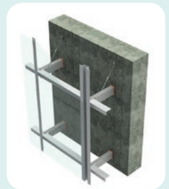
Doble capa. Orientación horizontal + vertical.
