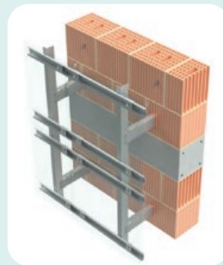
Doble capa. Orientación vertical + horizontal.
